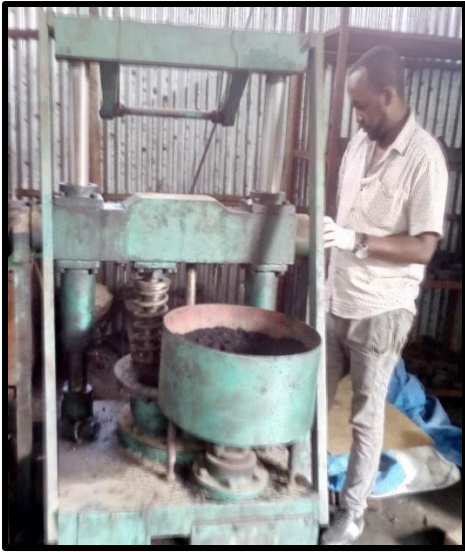
a.) Beehive Briquette Machine
